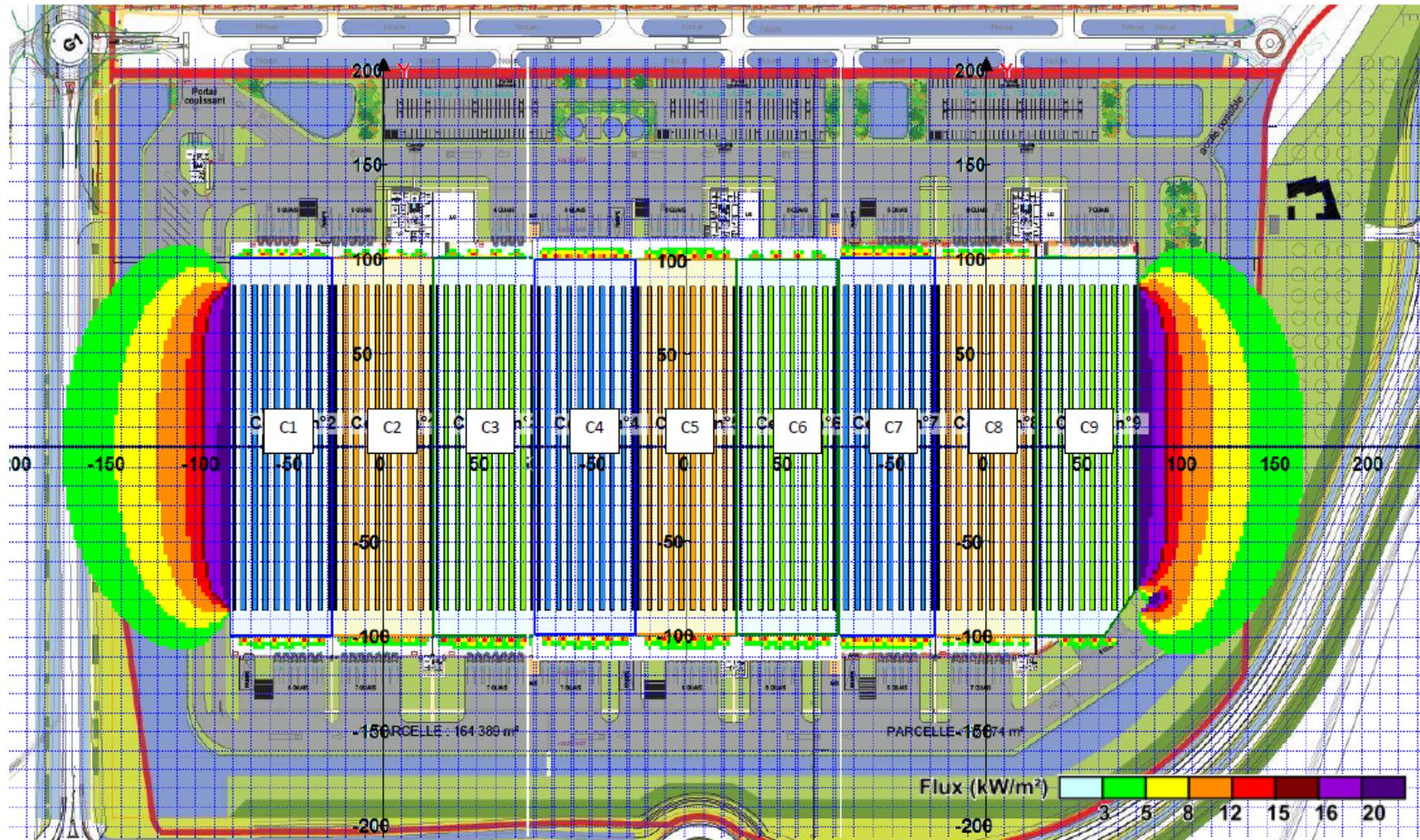
**Plan 5 : Zones enveloppes des effets thermiques rayonnés en cas d'incendie généralisé des cellules exploitées en stockage 2662 – PHASE 2**
